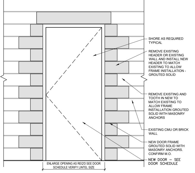
TYPICAL DOOR INSTALLATION IN EXISTING MASONRY WALL
